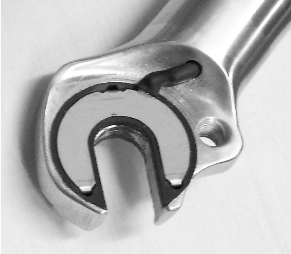
rechtes Ausfallende mit montierten Kontaktteilen
